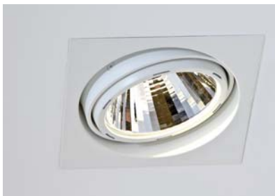
Bei den LED-Reflektoren des Schweizer Lichtunternehmens RD Leuchten AG stehen vier Ausstrahlungswinkel 12°, 26°, 36° und 60° zur Auswahl. Diese erreichen Wirkungsgrade von circa 90 Prozent. Zugleich haben sie eine mittlere Lebensdauer von 50.000 Stunden und senken in diesem Zeitraum den Lichtstrom um maximal 30 Prozent des nominalen Wertes.
